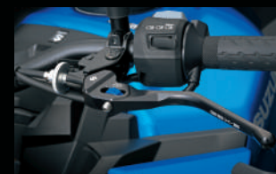
Maneta de embrague mecanizada (anodizada)
