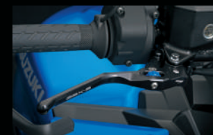
Maneta de freno mecanizada (anodizada)
